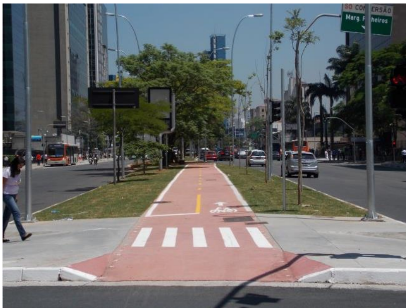
Figura 9-2 - Ciclovía bidirecional no canteiro central da Av. Faria Lima. [93]
