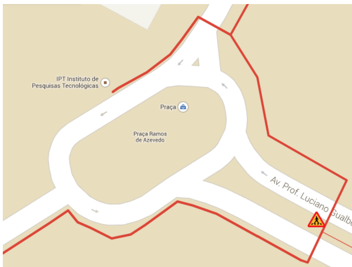
Figura 10-47 - Esquema da ciclovia proposta para a rotatória da Praça Ramos de Azevedo
