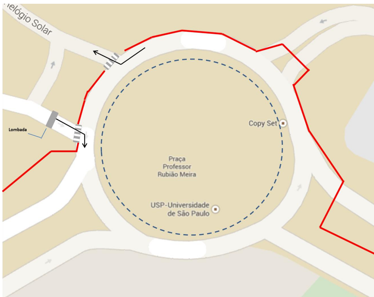
Figura 10-31 – Representação esquemática da solução a ser adotada na Rotatória da Praça Prof. Rubião Meira.
