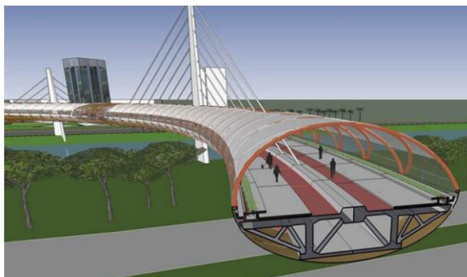
Figura 7-10 - Ilustração do corte vertical da ciclop passarela[82]
